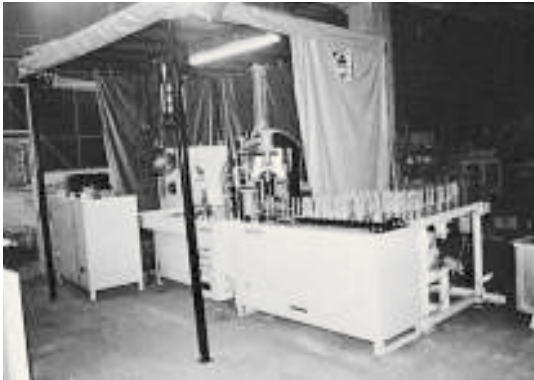
大型ブレード用ターンテーブル式自動探傷装置 コンベア搬入から自動チャックにてターンテーブル へ移送、回転、磁化、動作まで全自動で行います
