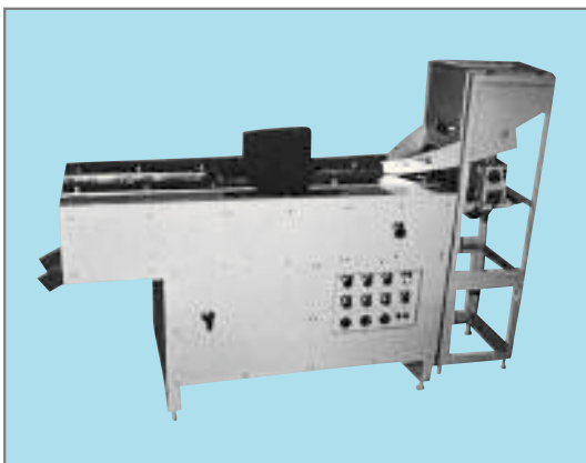
自動貫通脱磁装置 ワッシャーなどの超小物部品の脱磁装置でパーツ フィーダーから少量ずつ搬入し脱磁します
